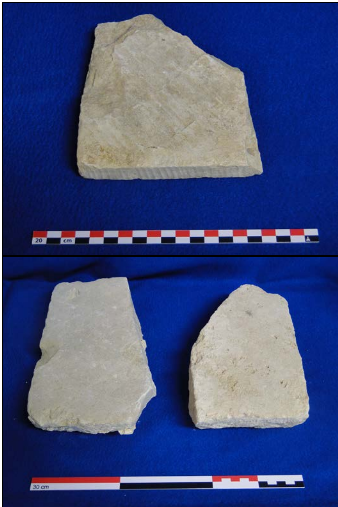
Afbeelding 61. Vloertegels van Gobertange / Ledestein met nog zichtbare scharreerslag (boven), uitwering van het oppervlak of gladde afslijting door belopen (onder).
